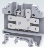
CTC4U 49.5 x 47 x 6 mm 0.2 - 4.0 mm 2 6.3 x 0.8 mm Tab 32 A, 300 V
