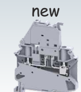
CYF4 / CYF4L 71.6 x 58.7 x 6 mm 0.2 - 4.0 mm 2 10 A, 1000 V, 0.5 Nm
